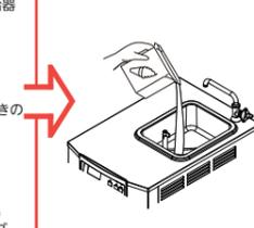
冷却スイッチを押す。冷却ランプが点滅する。
