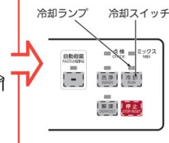
冷却ランプが点灯に変わり、表示が切り換われば出来上がり。
