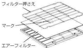
このとき、フィルター枠とフィルター押さえが汚れていたら掃除してください。
