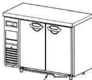
排水ホース 〈冷凍庫〉
