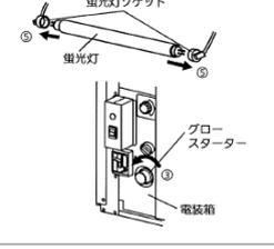
**蛍光灯交換のしかた 冷蔵タテ型SSRの例2**
